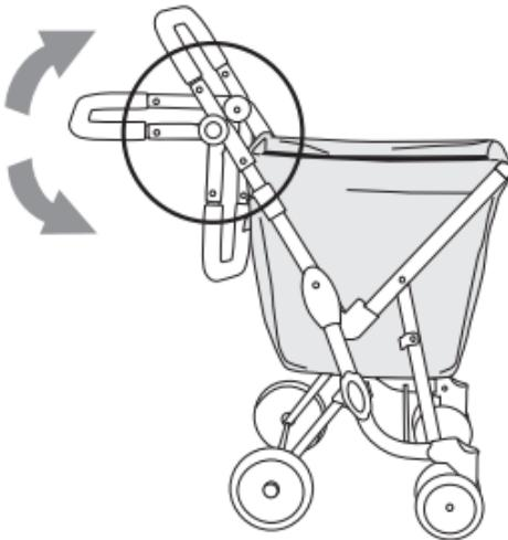
**E** Manillar regulable en altura con empuñadura de espuma. Cambio de posiciones pulsando los dos botones situados en los laterales.
