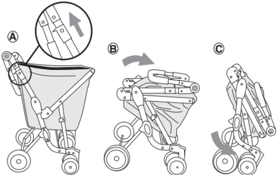
**Plegado:** Tire de los pulsadores hacia arriba y empuje hacia adelante(A,B). Compruebe que las ruedas traseras queden bien encajadas entre las ruedas delanteras giratorias (C).
