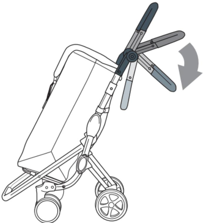
**E** Manillar regulable en altura con empuñadura de espuma. Cambio de posiciones pulsando los dos botones situados en los laterales.
