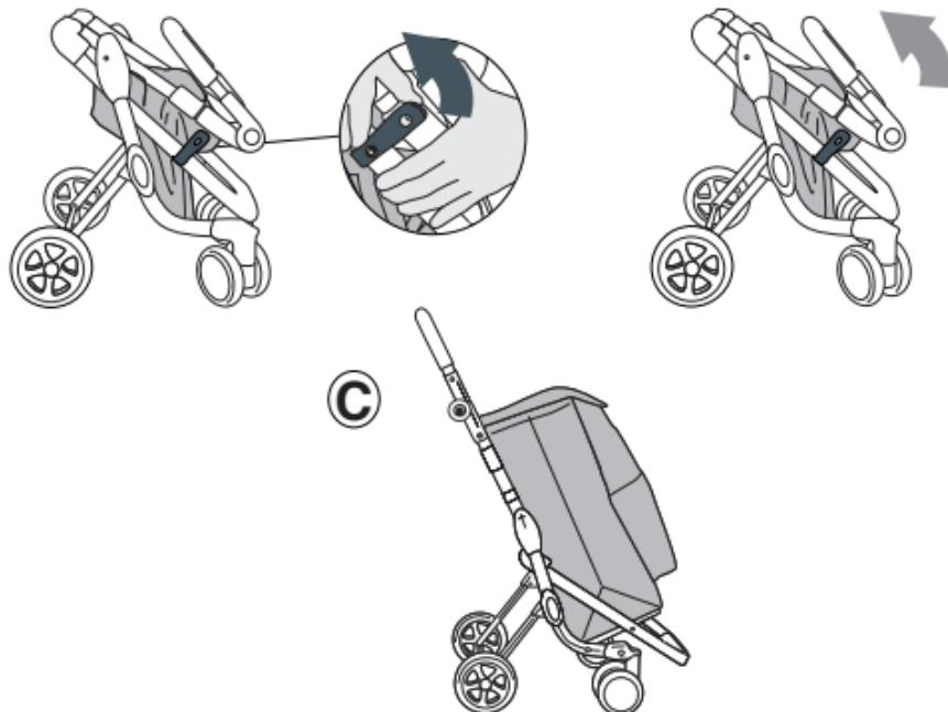
**E** **Desplegado:** Para desplegar el Go Up, libere el cierre de seguridad (A). Empuje hacia atrás el chasis hasta que un ‘clic’ indique su correcta fijación (B). A continuación, ajuste laertura de la bolsa y regule la altura del manillar (C).
