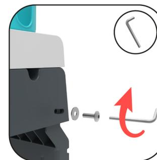
**3.8** Procéder au montage de l'ensemble avec 2 vis 6x20 (+ 2 rondelles) sur chaque côté. Ne pas serrer trop fort, juste vérifier un bon maintien de l'ensemble.
