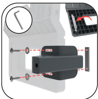
**2.1** Choisir le montage accoudoir gauche ou droite, puis fixer la demi-pince (I) sur le support vertical (F) avec 2 vis 6x20 (et 2 rondelles) via la plaque de vissage arrière (G).
