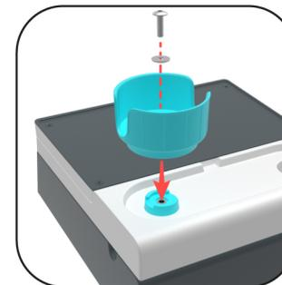
**3.5** Procéder au montage de l'ensemble avec une vis 6x20 + une rondelle.
