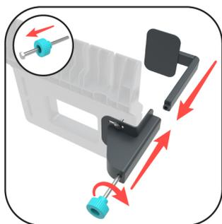
**2.2** Compléter la pince en insérant la partie (J) dans la partie (I) puis fixer l'ensemble avec la molette + vis de serrage (H)
