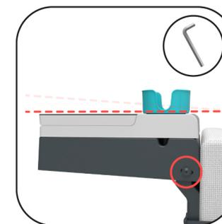
**3.9** Avant de bloquer les 2 vis, régler l'horizontalité par rapport à l'accoudoir et si besoin, ajuster la position finale avec la pince. Puis, serrer à nouveau la molette (H) si nécessaire.
